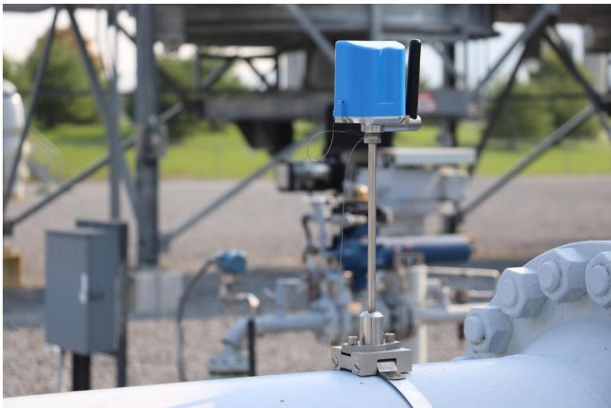
Одноэлементные сверхвысокотемпературные датчики: устанавливаются временно или постоянно с использованием металлической фольги в качестве контактной жидкости с ленточным зажимом диаметром от 2 до 36 дюймов и для температур до 932F/500C.
